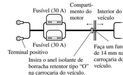
**2. Torça o cabo de bateria, cabo de terra e cabo de controle remoto de sistema.**
