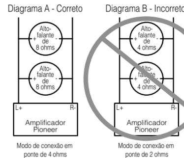
NÃO instale nem utilize o seu amplificador Pioneer conectando alto-falantes de 4 ohms (ou menos) em paralelo para obter um modo de conexão em ponte de 2 ohms (ou menos) (Diagrama B).
