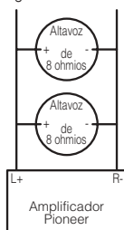
Modo de conexión en puente de 4 ohmios
