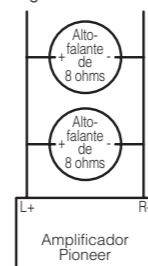
Modo de conexão em ponte de 4 ohms
